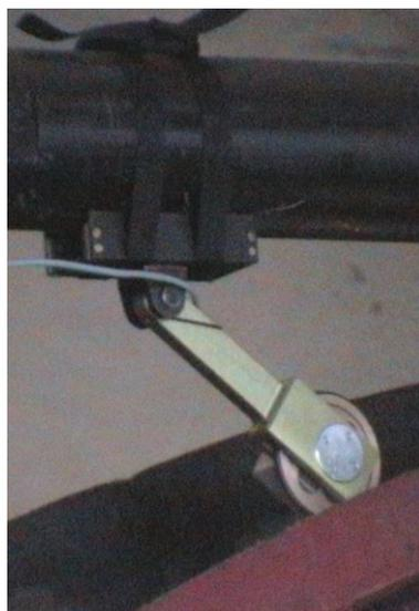
Рис. 5.3. Крепление датчика пути к тормозной тяге
