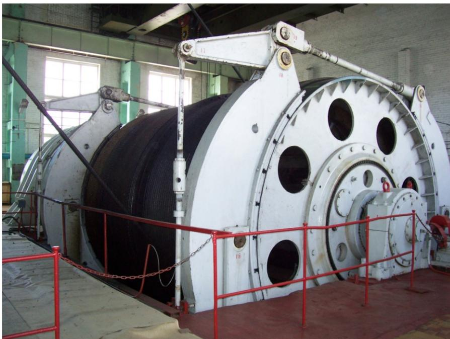
Рис. 1.4. Двухбарабанная подъемная машина
