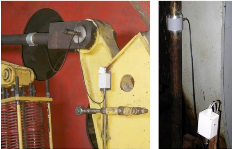
Рис. 2.7. Расположение датчиков деформации на тормозных тросах
