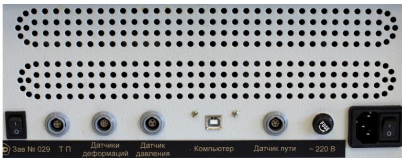
Рис. 5.7. Задняя панель блока коммутации
