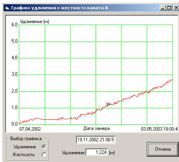
Рис. 3.50. Диалоговое окно *Графики удлинения и жесткости каната*
