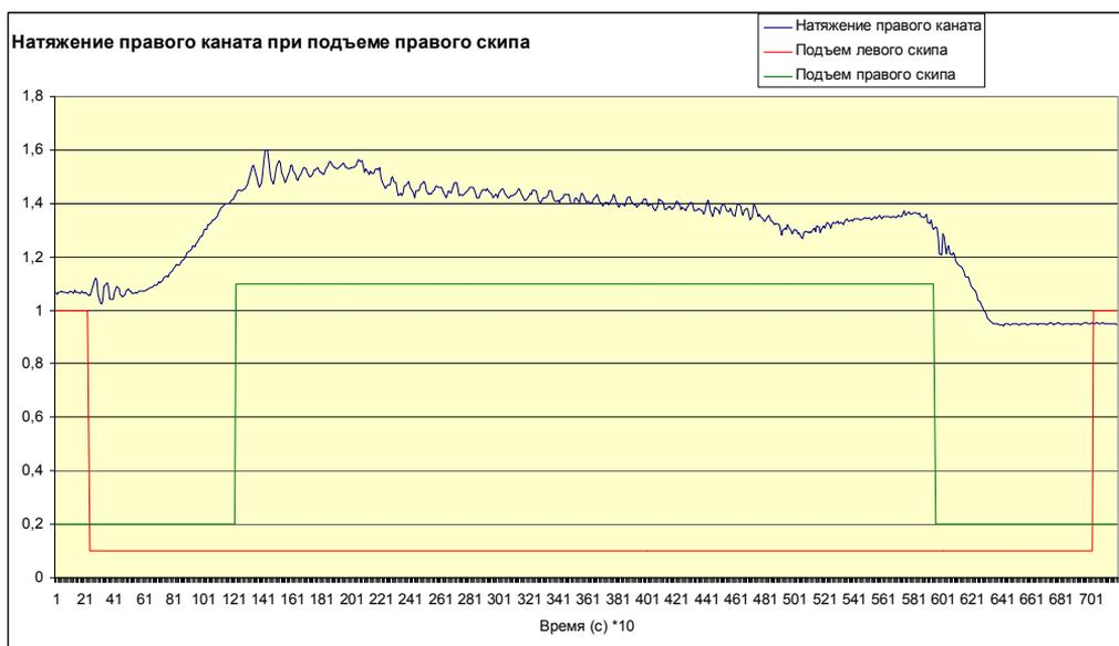
Рис. 6.5. Графики натяжения каната при подъеме груженого скипа
