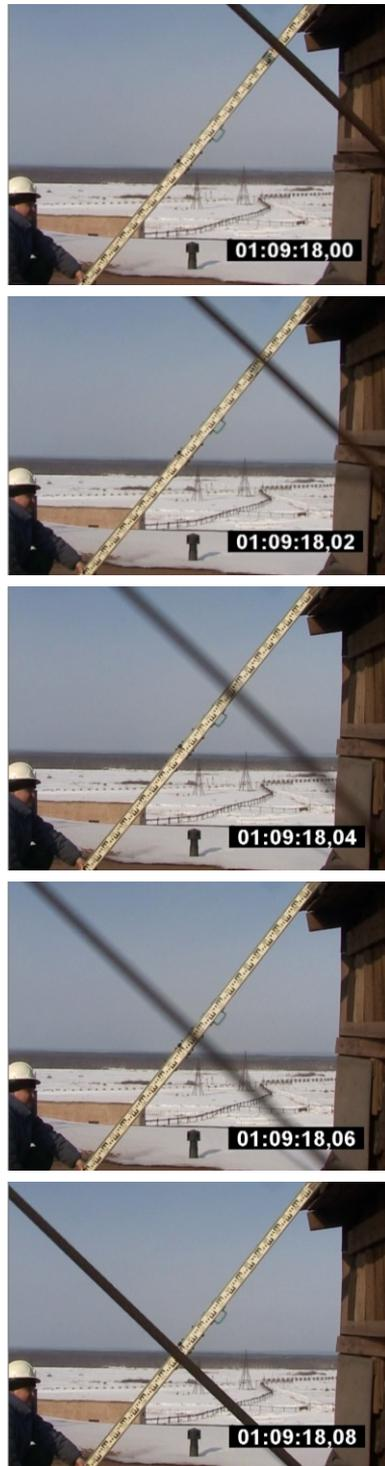
Рис. 9.5. Кадры видеосъемки перемещений каната на фоне геодезической рейки
