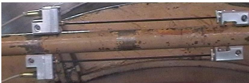
Рис. 5.4. Установка датчиков на тормозной тяге
