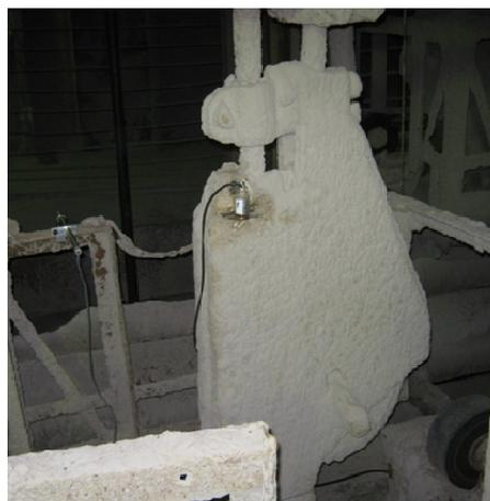
Рис. 9.2. Размещение датчика ускорения на скипе
