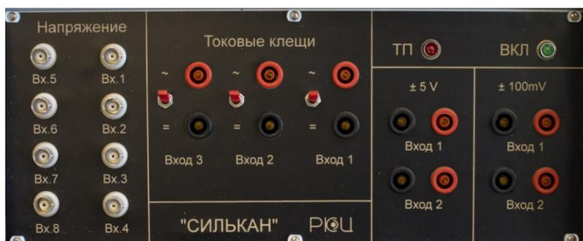
Рис. 5.6. Передняя панель блока коммутации
