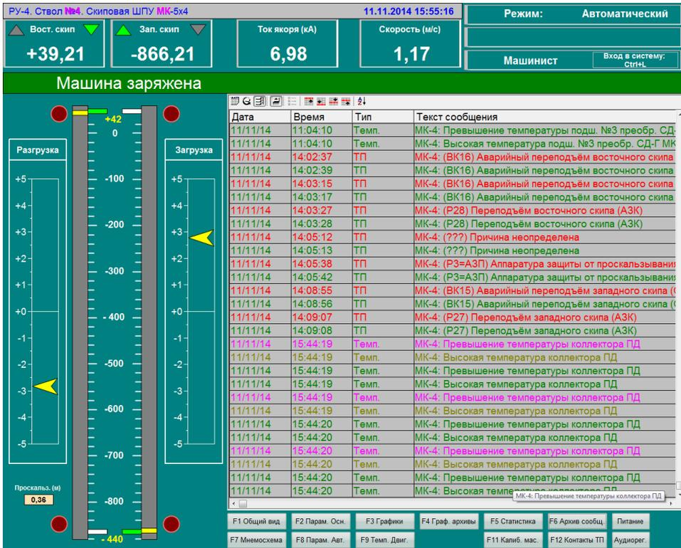
Рис. 3.16. Вид экрана со списком архива тревог
