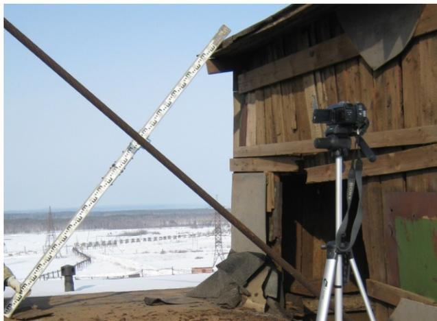
Рис. 9.4. Размещение видеокамеры и геодезической рейки при измерении амплитуды поперечных колебаний каната
