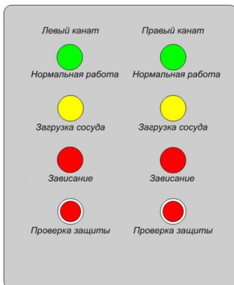
Рис. 6.8. Внешний вид индикатора натяжений канатов
