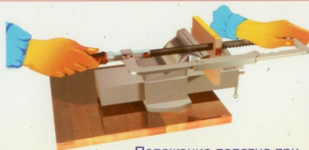
Положение полотна при глубоком прорезе
