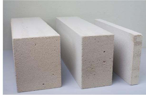
Ячеистый бетон – может использоваться в качестве теплоизоляционного материала
