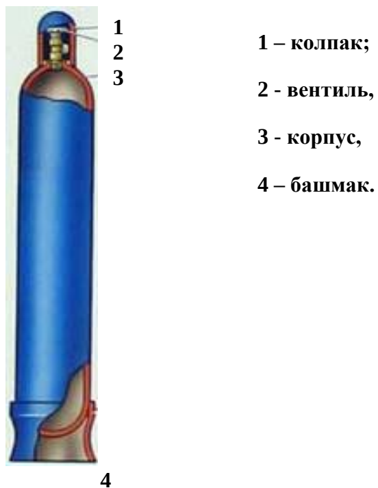
Рисунок 3 Общий вид кислородного баллона, с вентилем и установленным предохранительным колпаком
