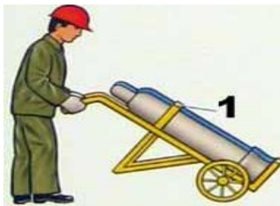
Рисунок 61 Перевозка на специальной тележке с рессорами на резиновом ходу
