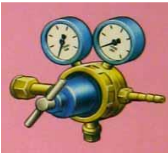
Рисунок 36 Вид манометров высокого и низкого давления на кислородном редукторе
