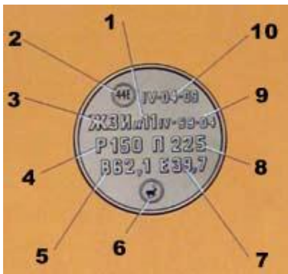
Рисунок 16 Пример нанесения клейма и расшифровка паспортных данных на баллоне
