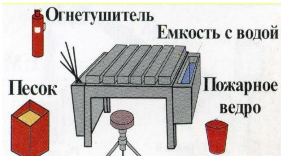
Рисунок 76 Средства пожаротушения стационарного поста для газокислородной резки
